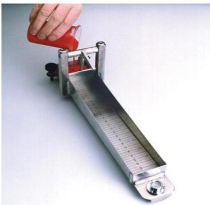
Рис.4.1 – Консисометр Боствика
